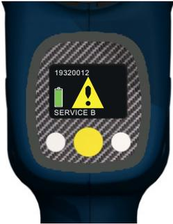
Die Servicezähler können mit dem HST-Tool-Manager unter dem User „Service“ parametrisiert werden. Der jeweils eingetragene Wert wird mit 1.000 multipliziert, d. h. bei Eintragung 10 erscheint nach 10.000 Setzungen der Servicehinweis auf dem Display. Mit Eintragen einer 0 wird die Funktion deaktiviert.
